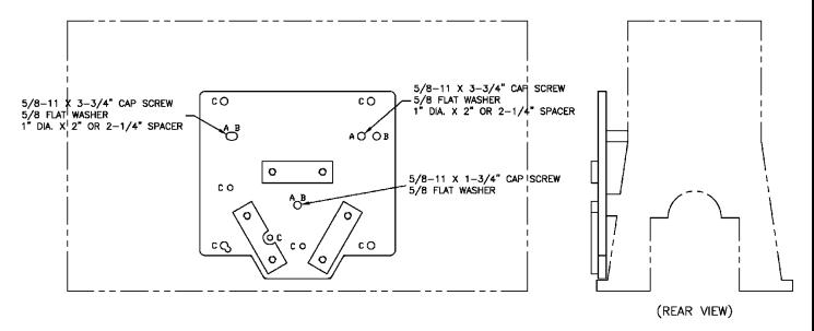
REMOVE STARTER MOTOR AND FUEL PUMP HOUSING FROM LEFT SIDE OF ENGINE.
